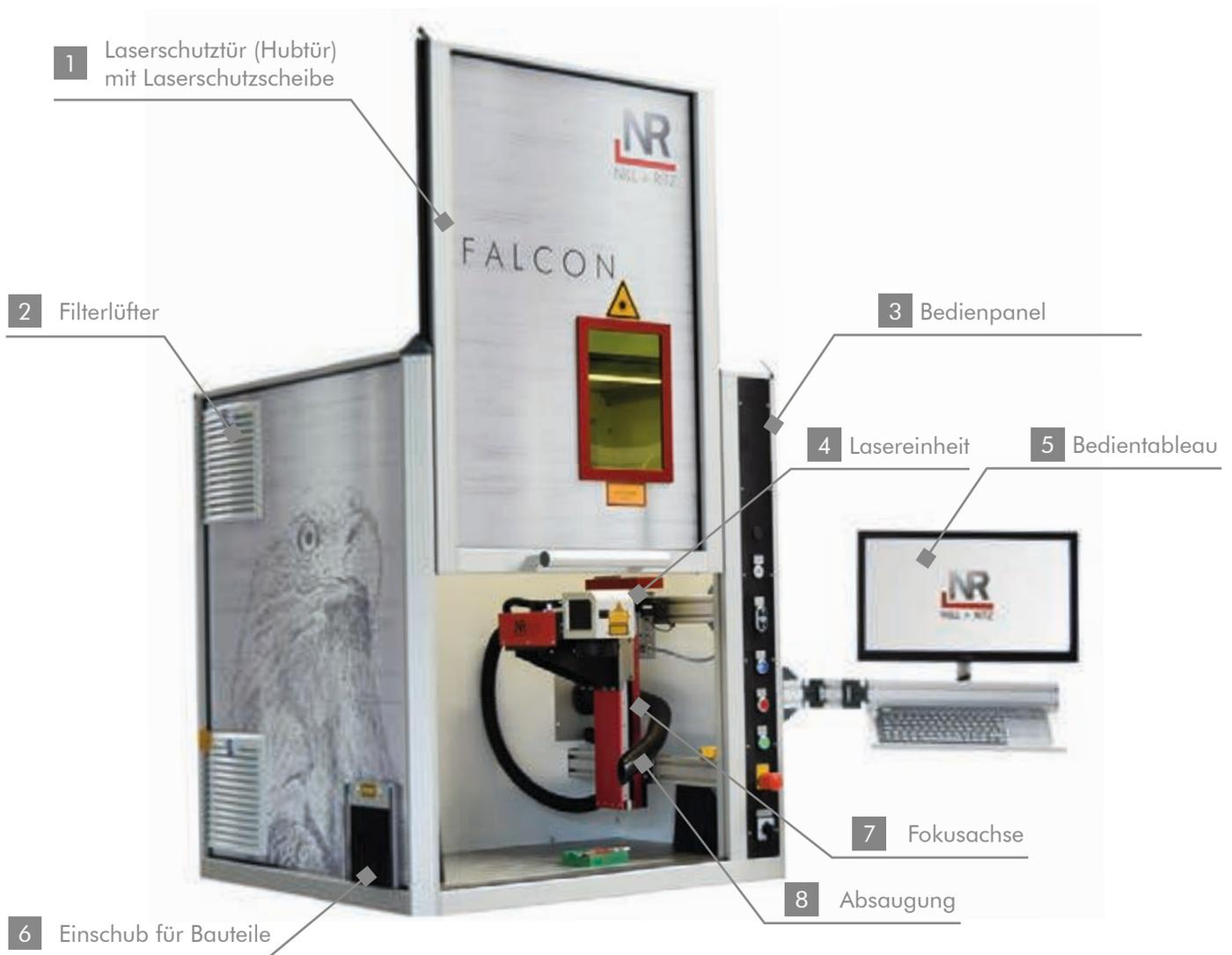
**KOMPAKT:** „All-in-one“: Laserquelle, Galvokopf, Linse und Steuerelektronik in einem.
